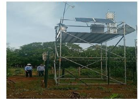
Estación ZM3 Loma Dos Estación ZM13 El Hatillo Ilustración 2. Equipos automáticos que hacen parte del Sistema de Alertas Tempranas.
